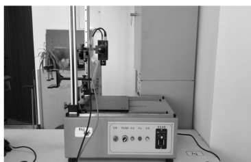
图4 采集木板近红外和可见光图像的多光谱图像采集装置
